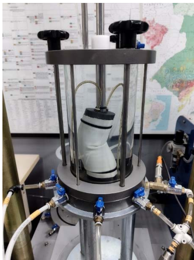
Figura 6. Perda de estrutura do corpo de prova ao final do ensaio sob tensão confinante de 50KPa.
