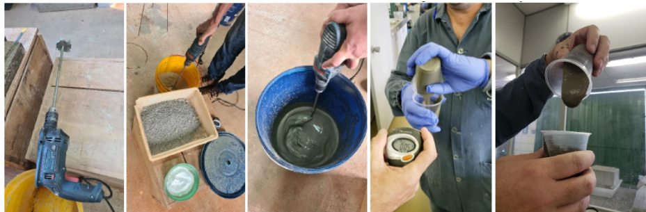
Figura 3. Mistura, preparo e determinação de gel time em laboratório.
