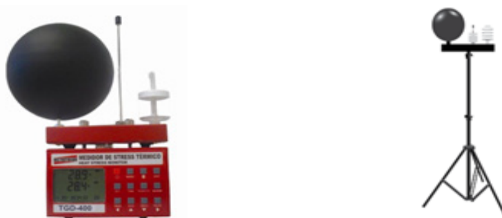
Figura 2: Medidor de Stress Térmico modelo TGD-400 do fabricante Instrutherm .
