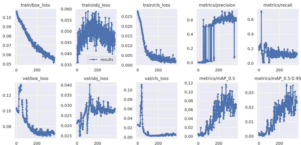
Figura 3 – métrica de avaliação do algoritmo de detecção de manifestações patológicas sem aplicação de *data augmentation*.
