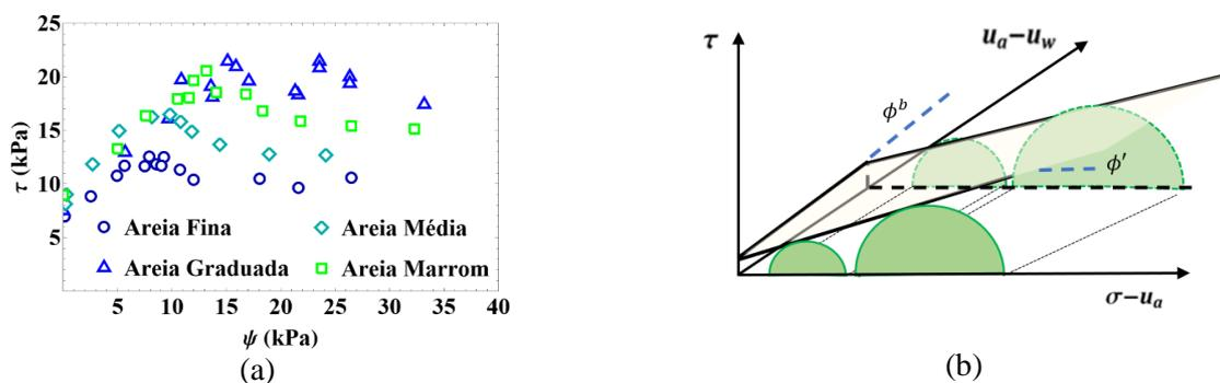
Figura 6. (a) Variação da resistência ao cisalhamento para areia de Brancaster (adaptada de Towner e Childs (1972)). (b) Envoltória de resistência de solos não saturados modelo de Fredlund *et al.* (1978).
