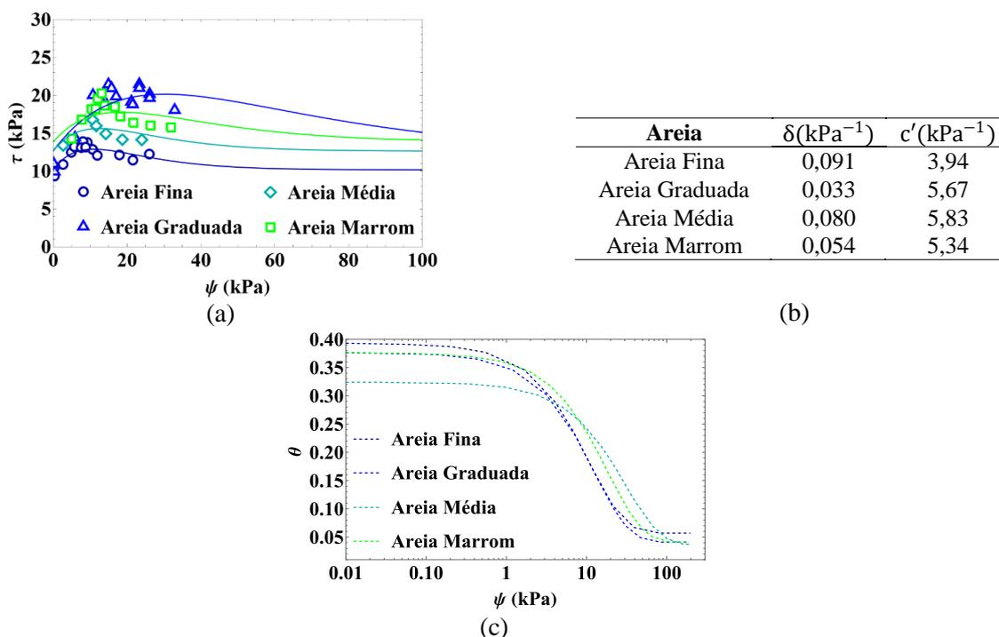
Figura 7. (a) Resistência ao cisalhamento *versus* sucção para as areias de Frankston obtidas por Donald (1956). (b) Parâmetros do solo ajustados. (c) Curva de Retenção de Água hipotética para as areias de Frankston com a suposição de que  $\theta_s$  é numericamente igual a porosidade e  $\theta_r=0$ . (adaptadas de Cavalcante & Mascarenhas (2021)).
