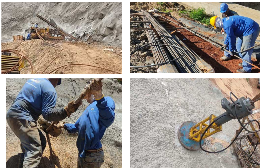
Figura 3. Execução do ensaio de arrancamento.
