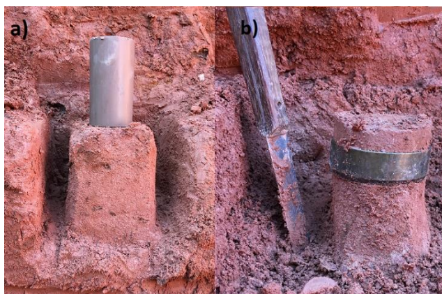
Figura 5. Retirada de amostras indeformadas (a) bloco para moldagem de ensaio triaxial (b) anel de cisalhamento direto
