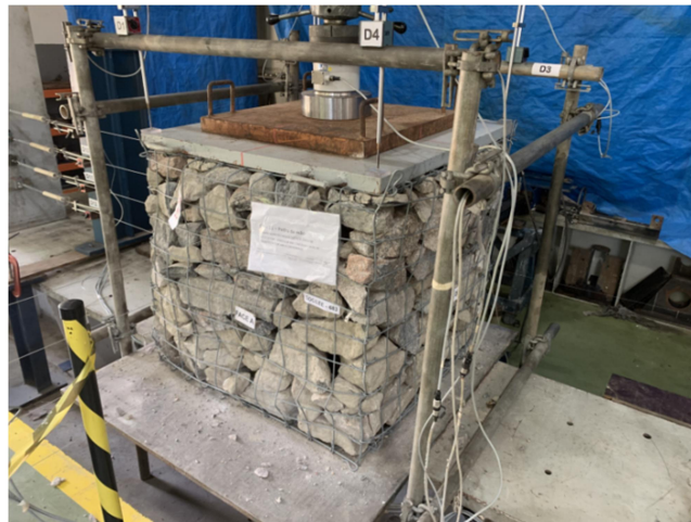
Figura 3. Deformação da caixa com malha de aço carbono revestido e pinos de conexão (Tipo C).
