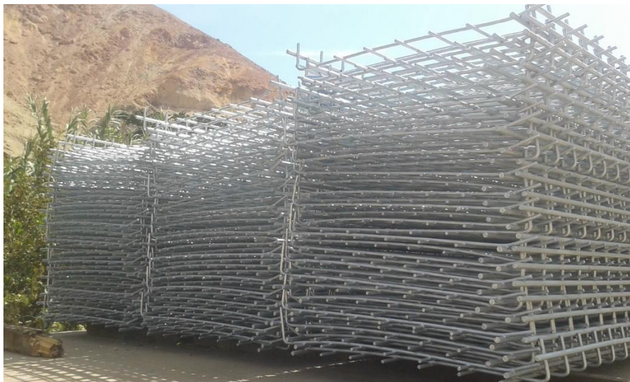
Figura 6. Painéis metálicos eletrossoldados galvanizados do paramento frontal da contenção. FONTE: Freyssinet Tierra Armada Perú S.A.C.
