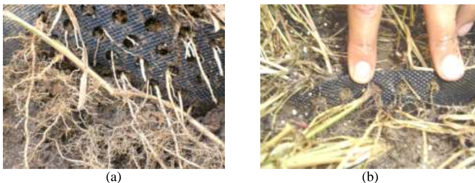
Figura 3. (a) e (b) Influência das geocélulas perfuradas e texturizadas às raízes vegetativas.
