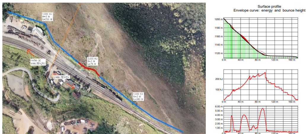
Figura 3-3: Configuração da solução proposta com barreiras dinâmicas, e seção de análise
