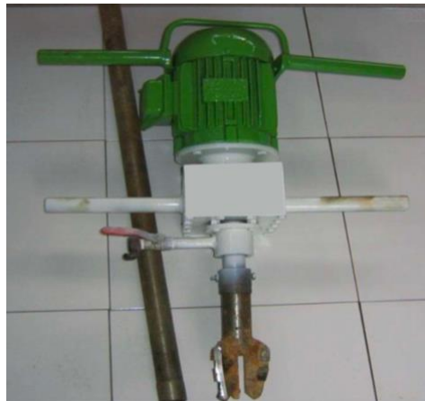
Figura 1. Vista típica da perfuratriz elétrica, com haste (à esquerda), bit de perfuração do tipo tricône e corpo da máquina, com motor fechado
