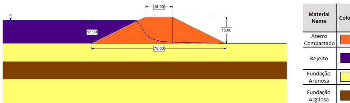
Figura 1. Seção fictícia e cores dos materiais utilizados
