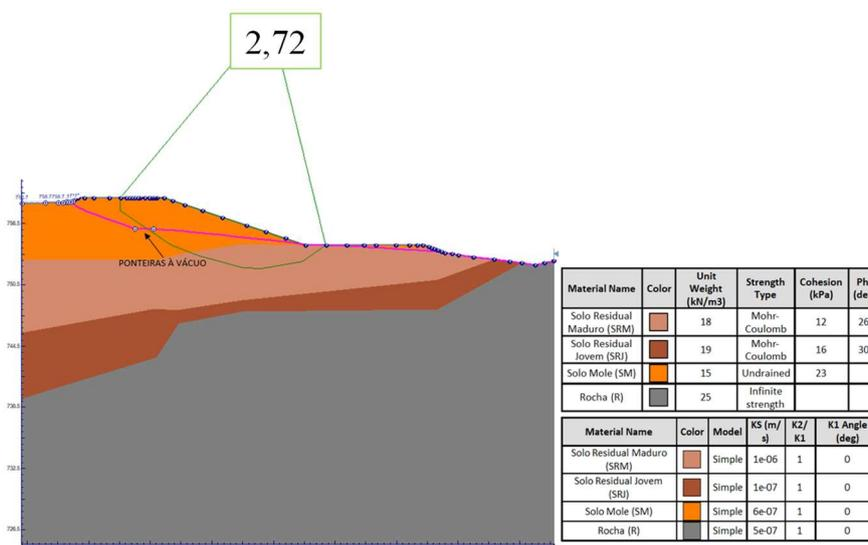
Figura 5. Seção A – Com ponteiros a vácuo.
