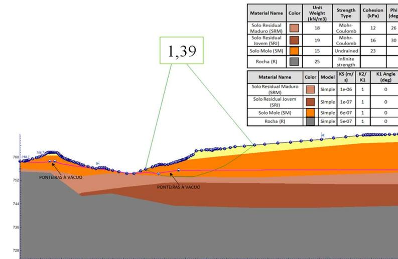
Figura 8. Seção C – Com ponteiros a vácuo – Esquerda Hidráulica (EH).
