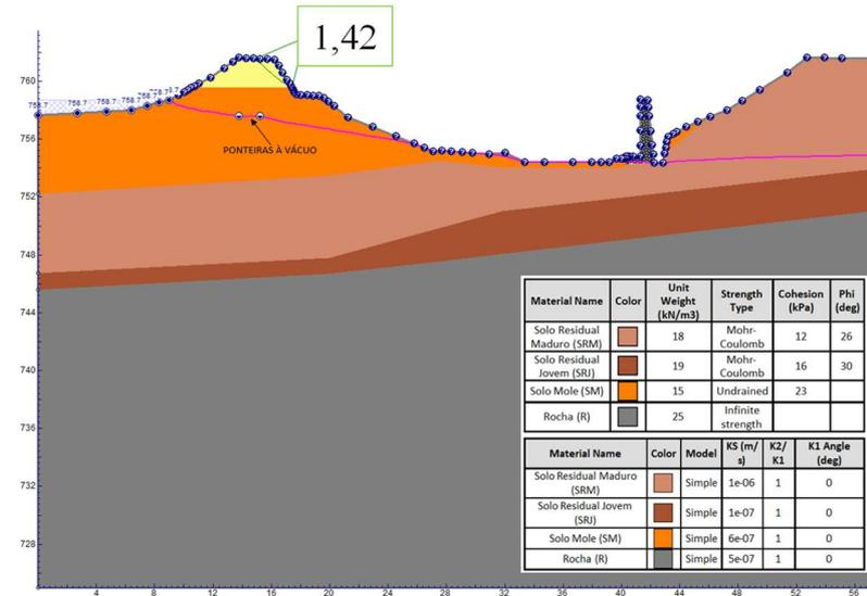
Figura 6. Seção B – Com ponteiros a vácuo.
