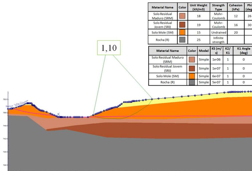
Figura 4. Seção C – Esquerda Hidráulica (EH), sem ponteiros a vácuo.
