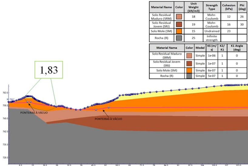
Figura 7. Seção C – Com ponteiros a vácuo – Direita Hidráulica (DH).
