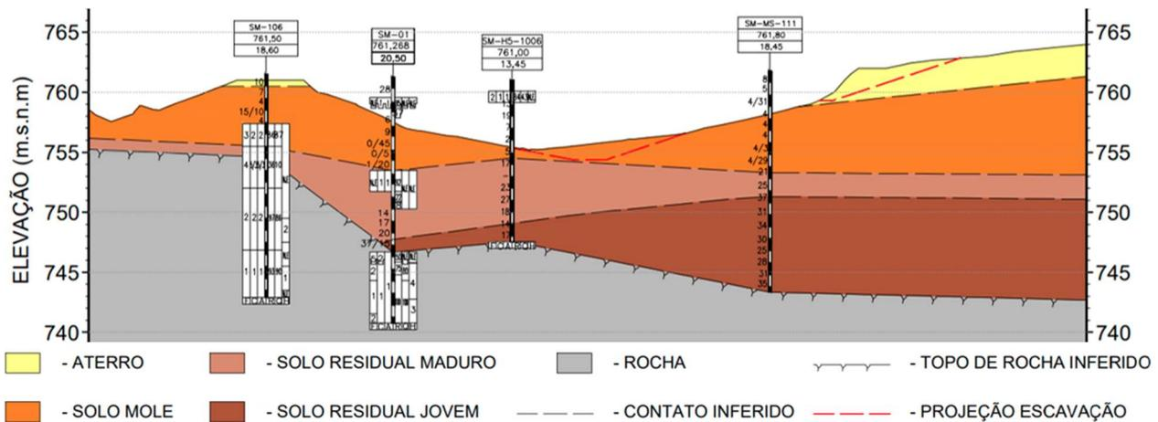
Figura 1. Seção geológico-geotécnica.
