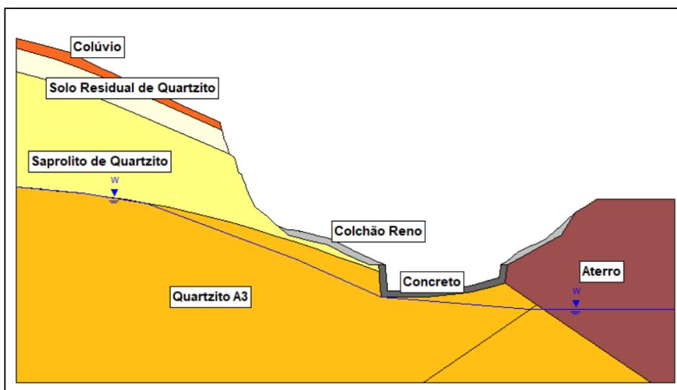
Figura 1. Modelo geológico – Seção de referência
