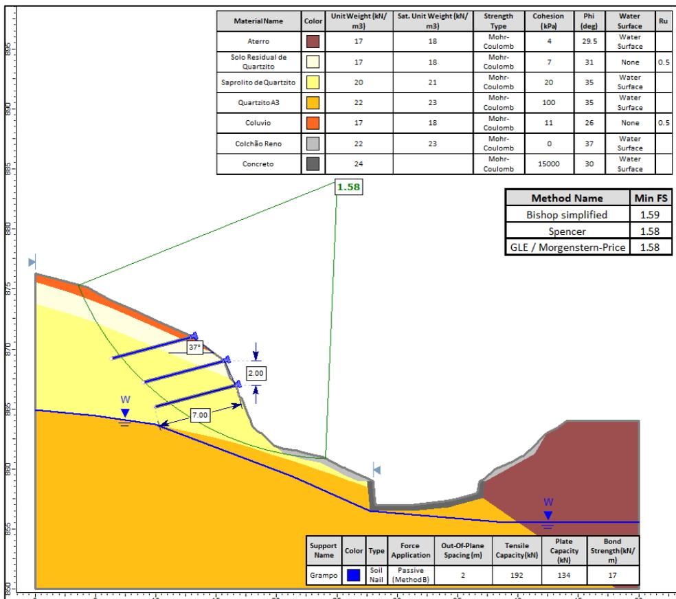
Figura 3. Análise de estabilidade – Condição Reforçada
