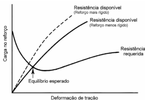
Figura 7 - Curva de compatibilidade para determinação do equilíbrio do solo reforçado (Modificado - Jewell, 1996)
