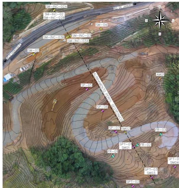
Figura 4. Plano de investigação geotécnica e alinhamento do perfil.
