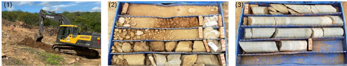
Figura 3. (1) Execução das trincheiras de reconhecimento, (2) e (3) testemunhos de sondagem SPT e Rotativa.
