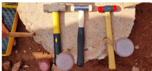
Figura 2. Martelos utilizados no ensaio PIT. Fonte: Imagem do autor.
