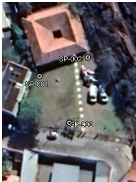
Figura 2. Localização dos furos de sondagem. Fonte: Adaptado de Alencar Sondagens (2022)
