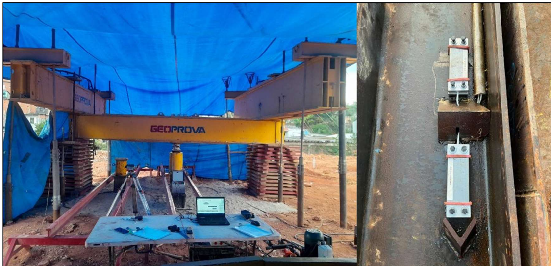
Figura 4. A esquerda: montagem da prova de carga utilizando reações no sistema SAP. A direita foto dos sensores resistivos ( strain gages ) utilizados.
