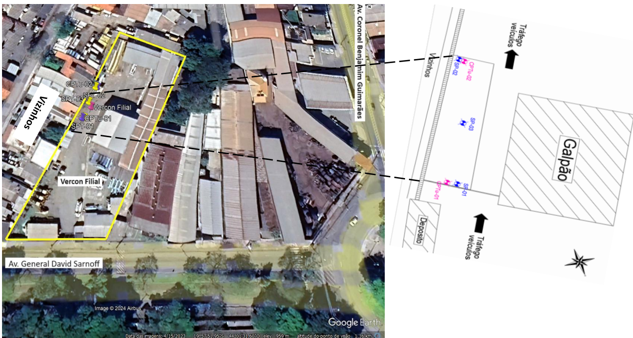
Figura 1. Campo experimental do P&D tirantes em Contagem – MG: localização da Vercon Industrial – Filial, com identificação dos ensaios geotécnicos realizados.
