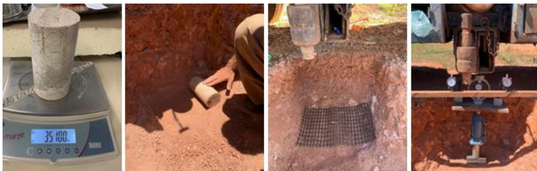
Figura 5. Detalhes da montagem das provas de carga.
