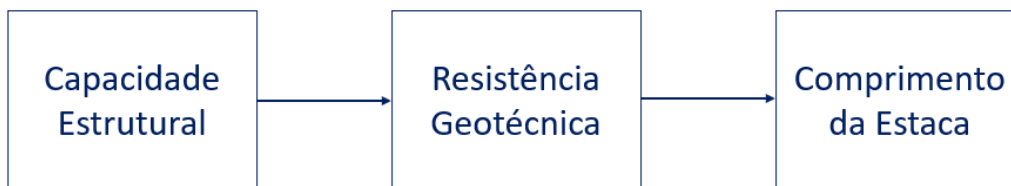
Figura 2. Comprimento da estaca em função da Capacidade Estrutural
