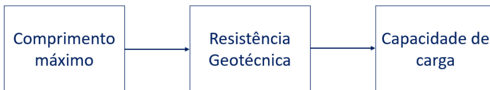
Figura 3. Capacidade de carga em função do comprimento máximo
