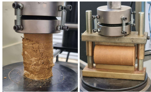
Figuras 4 e 5: Compressão simples (esquerda) e tração indireta (direita) Fonte: Autores.
