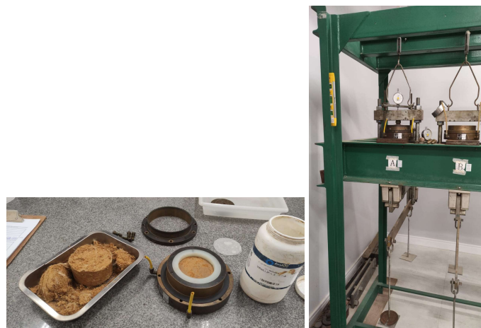
Figuras 6 e 7. Montagem do corpo de prova na célula de adensamento (esq.) e equipamento de compressibilidade (dir.).
