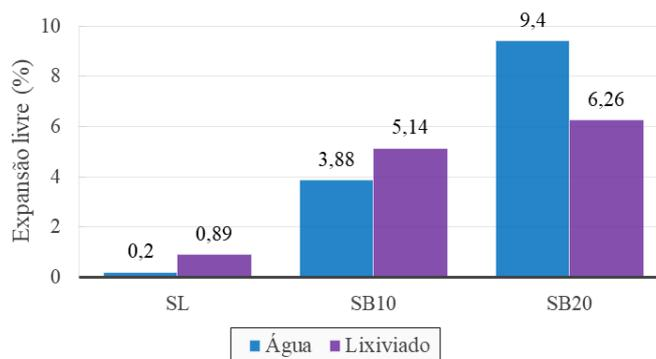
Figura 5 – Expansão livre das amostras SL, SB10 e SB20
