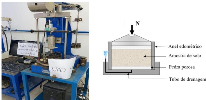
Figura 2 – Ensaio de expansão livre em aparelho de adensamento automatizado
