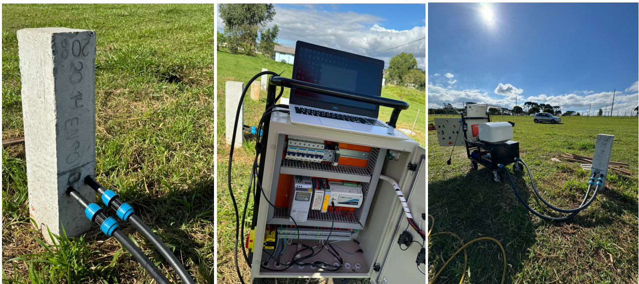
Figura 3. (a) Estaca com tubo trocador de calor de entrada e saída. (b) Sistema eletrônico de captação de dados. (c) Teste de Resposta Térmica em andamento no CEEG-PG.
