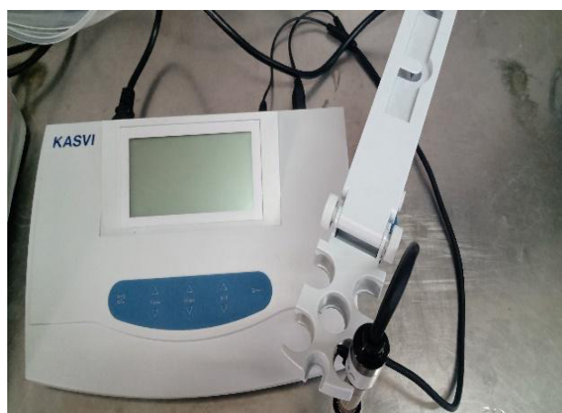
Figura 5. pHmetro modelo mPA210.
