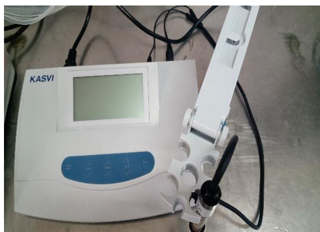
Figura 8. pH metro modelo mPA210.
