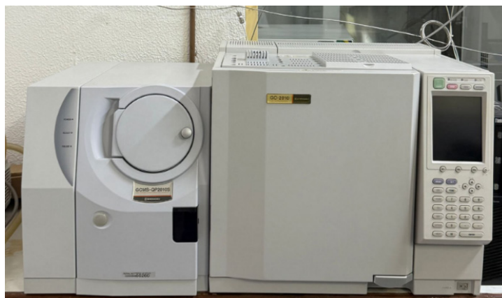
Figura 5: Cromatógrafo Gasoso acoplado a Espectrômetro de Massas (CG-EM), utilizado para a separação, identificação e quantificação dos constituintes voláteis de óleos essenciais com base em seus tempos de retenção e espectros de massas.
