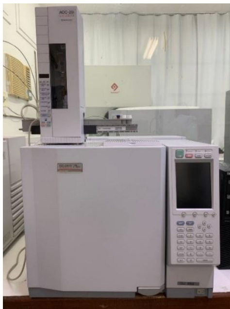
Figura 6: Cromatógrafo Gasoso acoplado a Detector de Ionização de Chama (CG-DIC), empregado na separação e quantificação de constituintes voláteis com base em seus tempos de retenção e resposta de massa.
