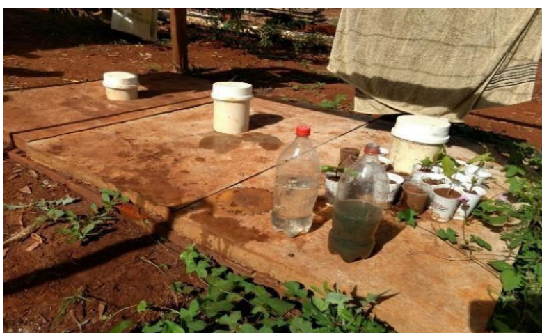
Figura 4 – Efluentes coletados no tanque séptico (alta turbidez) e na bacia de evapotranspiração (efluente incolor)
