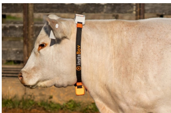
Figura 1 – Monitoramento eletrônico de bovinos com coleiras inteligentes RFID conectadas a sensores térmicos.
