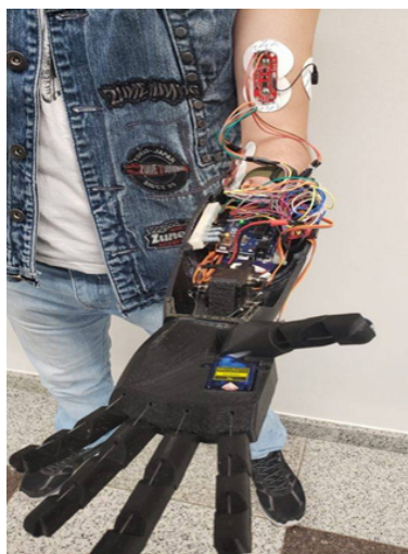
Figura 1: Prótese eletrônica com sistema de controle e sensores biomédicos integrados.
